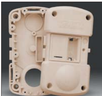
一款作业现场安全传感器壳体的 Z Corp 模型 (上图) 和实际产品 (右图)
