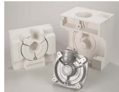
ZCast 3D 鋳型と鋳造アルミニウムパーツ
